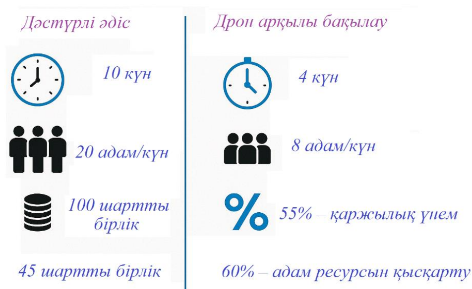
2.10-сурет – Дәстүрлі және дрон көмегімен жолды бақылау әдістерінің салыстырмалы тиімділігі
